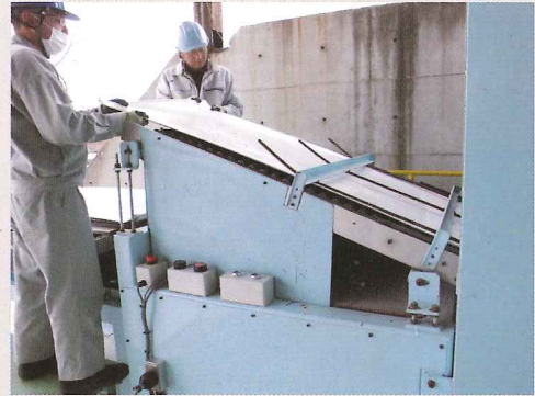
ガラスわけーるでガラス、セルを剥離し、バックシートを破碎する
