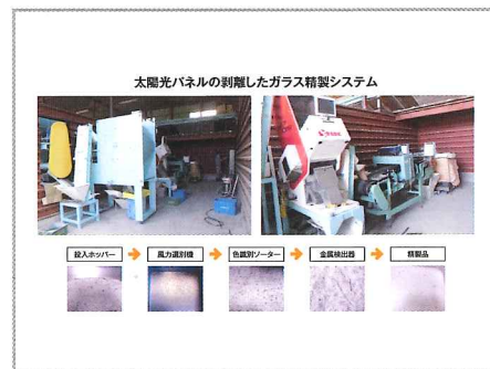
ガラス精製システム
